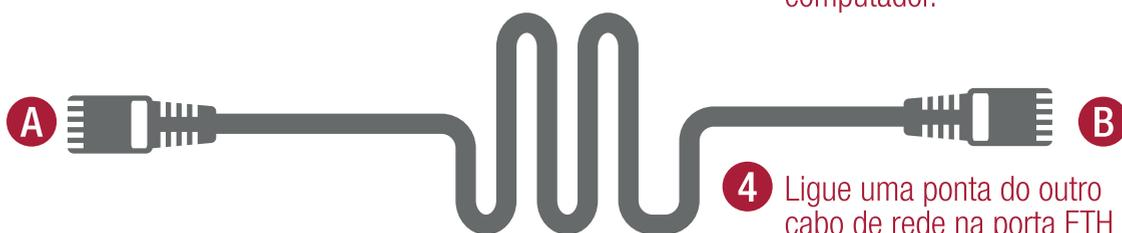
**4** Ligue uma ponta do outro cabo de rede na porta ETH do terminal, e a outra ponta em qualquer porta do switch.
